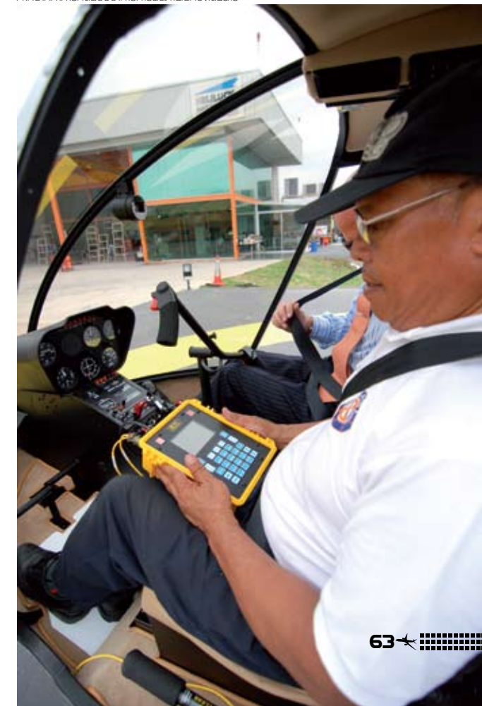
เจ้าหน้าที่กำลังตรวจสอบการสั่นไหวของตัวอากาศยาน
