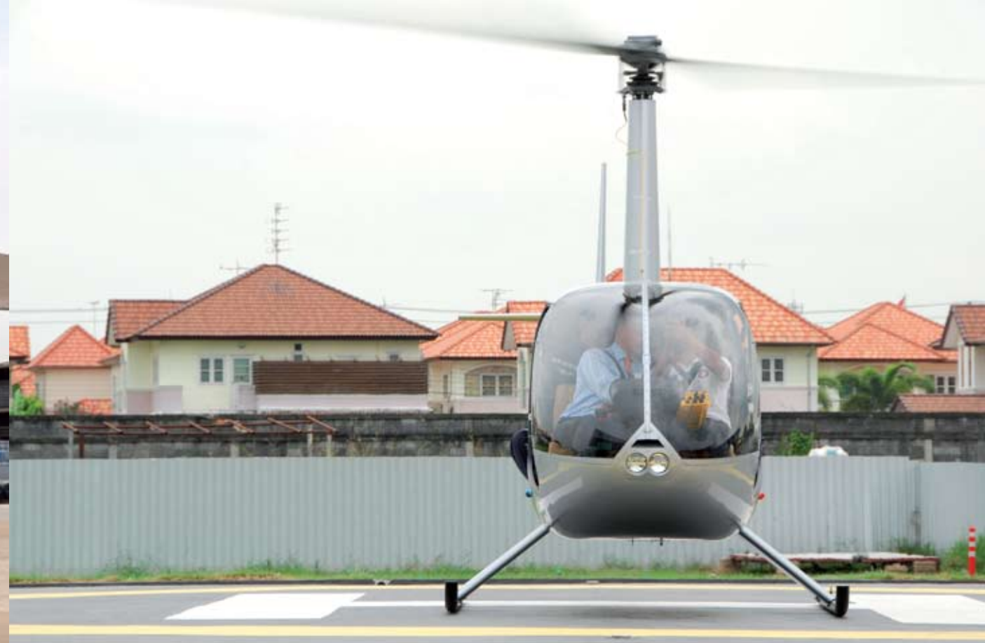
ทดสอบเครื่องยนต์ครั้งแรกหลังการปรับตั้งใบพัด
