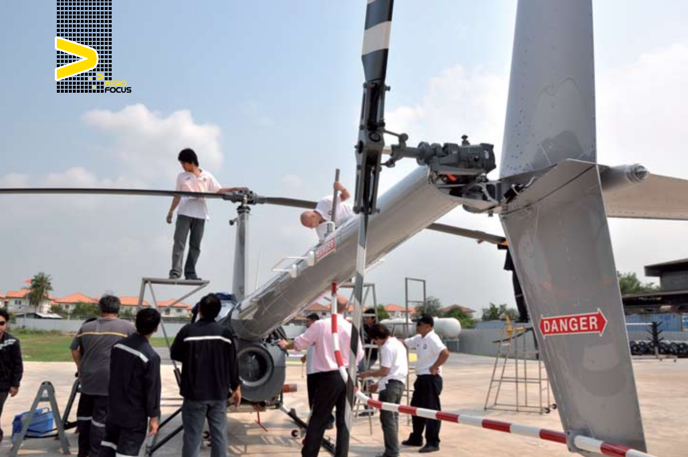
ขั้นตอนการติดตั้งใบพัดหลัก
